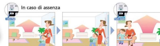
Prima di uscire, attivare la modalità di "Funzionamento in caso di assenza", e il climatizzatore regolerà la capacità fino al raggiungimento della temperatura precedentemente impostata per questa funzione.
